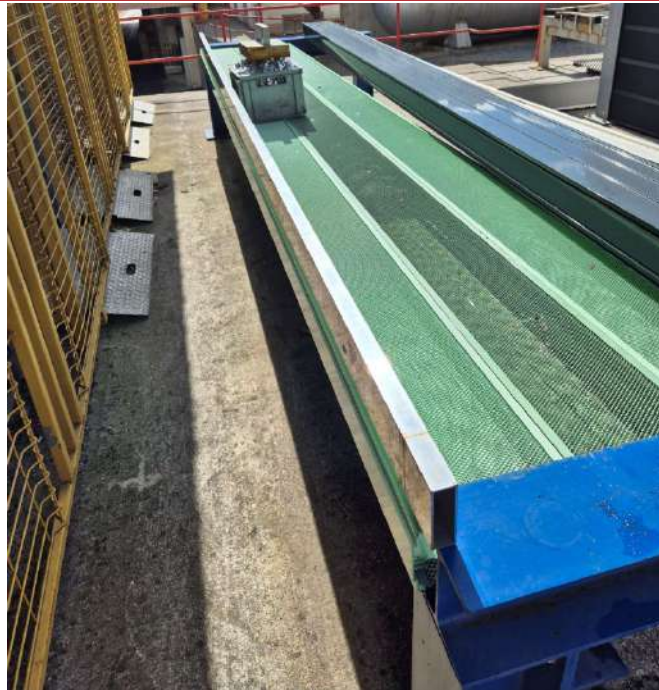
Abbildung 3. Darstellung des Profils nach Anbringen der Belastung
