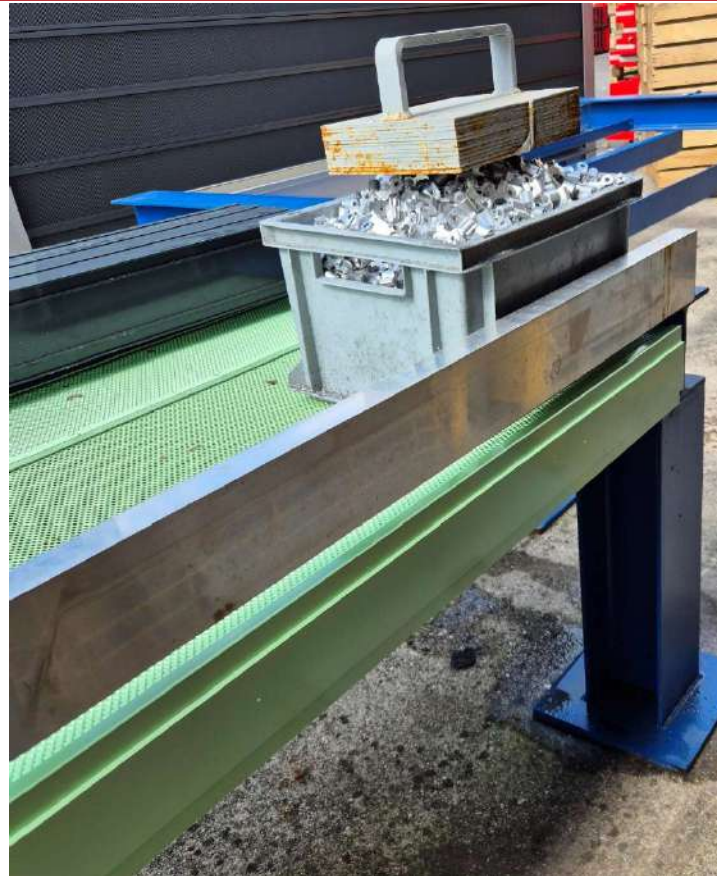
Abbildung 5. Darstellung des Profils nach dem Anbringen der Verstärkung am Ende
