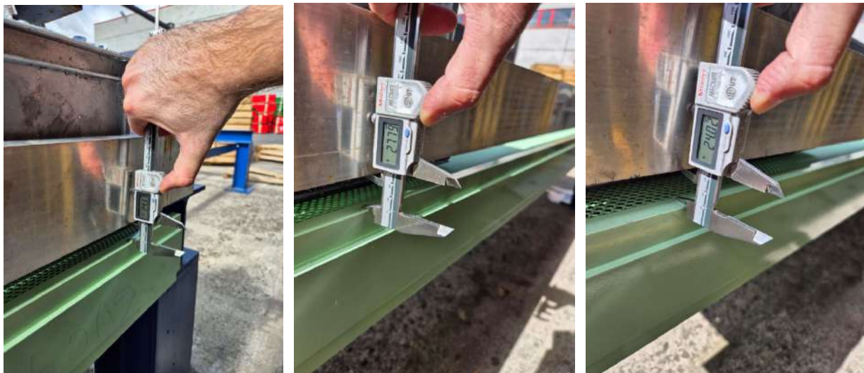
Abbildung 2. Anfang, Mitte und Ende nach Anbringen der Belastung von 42,8 kg
